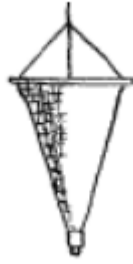
Рисунок 6.2 – Устройство планктонной сетки для глубоководных водоемов
